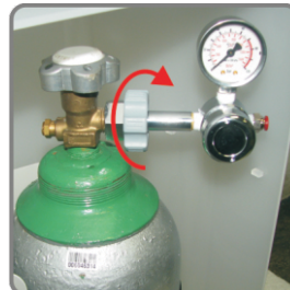
12-Apertar até prender a válvula no cilindro
