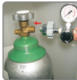
10-Posicionar a válvula
