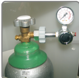
11-Encostar a válvula no cilindro
