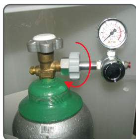
6-Desapertar a válvula.
