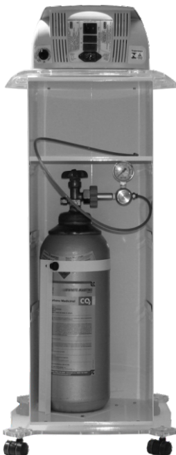
11-Encostar a válvula no cilindro
