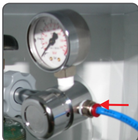
4-Pressione a argola da válvula redutora para dentro.
