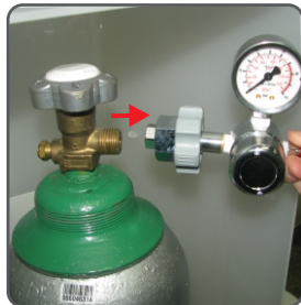
7-Retirar a válvula do cilindro.
