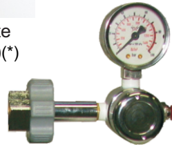
01 Válvula redutora de pressão(*) Válvula específica para carboxiterapia Fabricante : SMT - White Martins Máxima pressão de entrada : 60 bar Pressão de saída : 2,3 bar Conector de entrada : ABNT 209-1 Conector de saída : 6mm rápido
